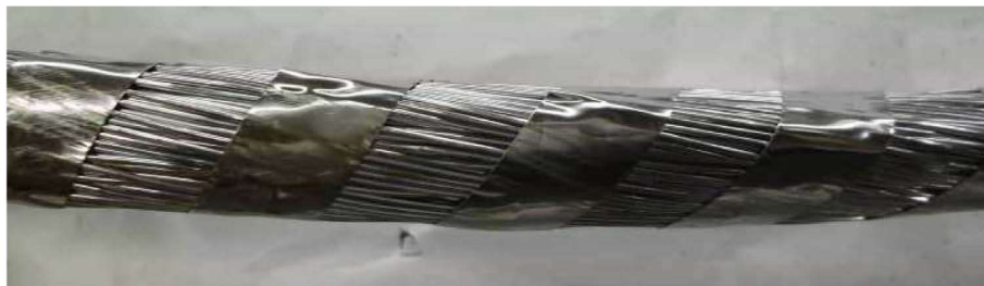
(d) TF conductor (pseudo long twist pitch)
